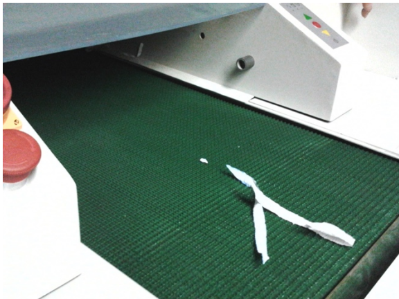
图 2：特制防滑输送带入纸口
