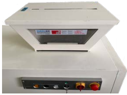
图四：平面入口和漏斗入口安全盖
