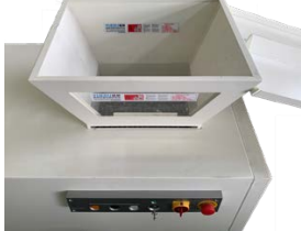
图四：平面入口和漏斗入口安全盖
